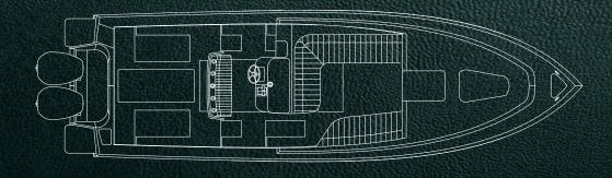
STANDARD FUEL: 237 GALLONS / BEAM: 9' 10" / LENGTH: 32' 7" / WATER: 20 GALLONS
